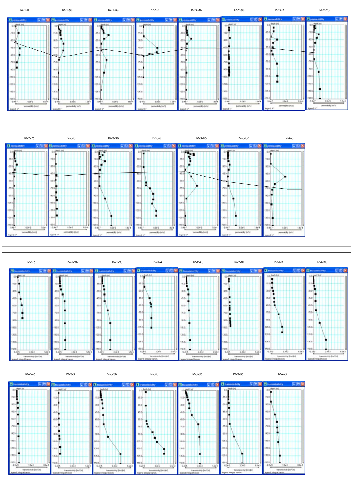
Figura 18. En la parte superior se muestran los gráficos de la permeabilidad k (m/s) en función de la profundidad para los SRM del perfil P1. La línea negra representa el muro del acuífero aluvial. En la parte inferior se muestran los gráficos de transmisividad acumulada en función de la profundidad para el mismo perfil.
